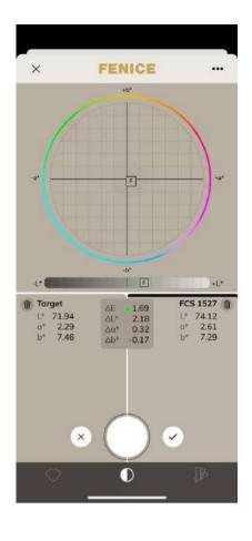
Una volta pesato il colore, applicarlo in una zona nascosta, verificando che sia ben asciutto (la tonalità del colore cambia dopo l'asciugatura) e posizionare il lettore sul colore appena campionato. In questo caso abbiamo commesso un evidente errore di pesatura per dimostrare l'utilizzo della correzione.
