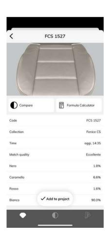
La funzione "Formula Calculator" permette di calcolare automaticamente in modo istantaneo i grammi da pesare di ciascun colore in base a quanto colore si necessita:
